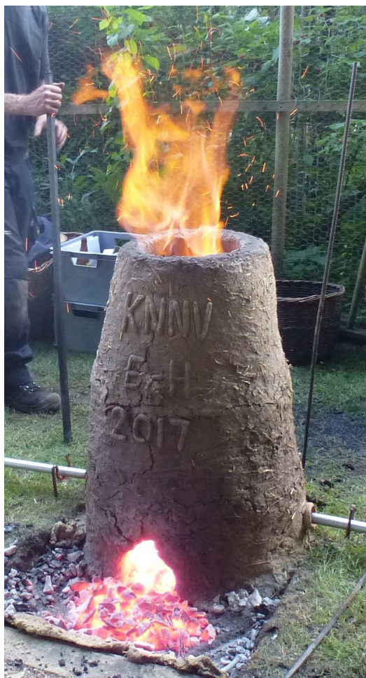
De oven in vol bedrijf. Binnenin wordt een temperatuur van 1100 tot 1200° C bereikt, waardoor de stenige massa uit de klappersteen smelt en het ruwe ijzer (de wolf) samengeklonterd in de oven achterblijft.
